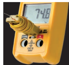
K-típusú termoelem dugaszok Közvetlenül a műszerbe (SC240/SC260)
